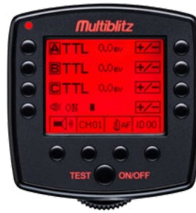
TTL TRIGGER C E-TTL-Funkfernbedienung für CANON
